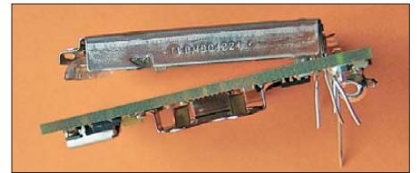
Bild 5: Das LC-Display ist mit Drahtschlaufen fest auf die Platine zu drücken.
