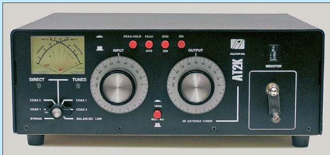
Bild 1: Unsymmetrischer Antennenkoppler Palstar AT2K in T-Hochpassschaltung für 1,8 MHz bis 54 MHz
