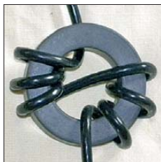
Bild 12: So wird ein 1-kW-Balun mit FT240-43 und Aircell 5 aufgebaut. Fotos: DK7ZB
