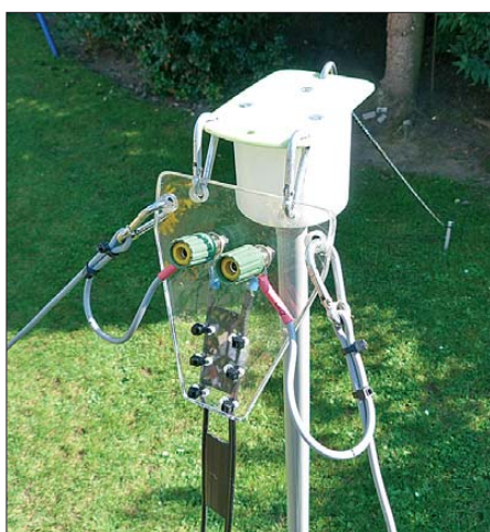
Mittensisolator an der Mastspitze mit eingehängten Dipolhälften Fotos: DJ5RE
