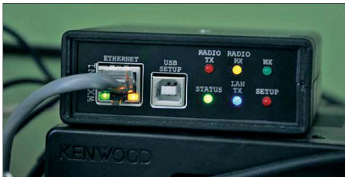
Bild 1: Die Statusanzeige mittels LEDs leistet gerade während der Installation wertvolle Dienste, da so Rückschlüsse über den Datenfluss möglich sind.
